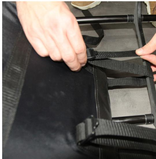
Binden Sie die Hinterseite des Sitzes an dem Spant.
