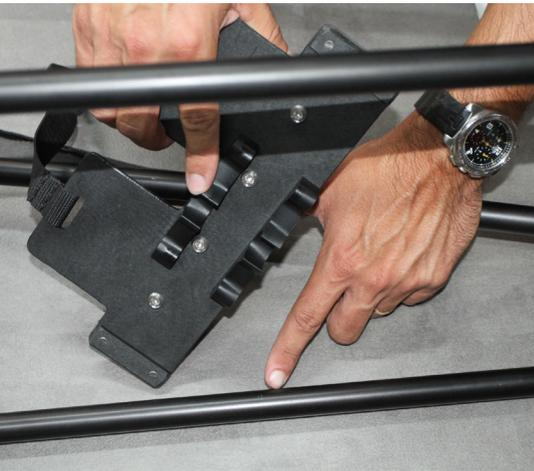
Die Fußstütze verbindet sich auf dem Kielsrohr, dank der Stützen die sich unten dem Plättchen befinden.
