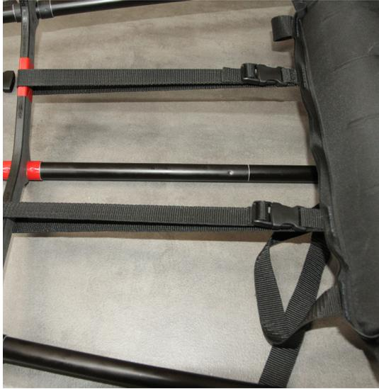
Binden Sie die Vorderseite des Sitzes an dem Spant mit den engen Gurten fest.
